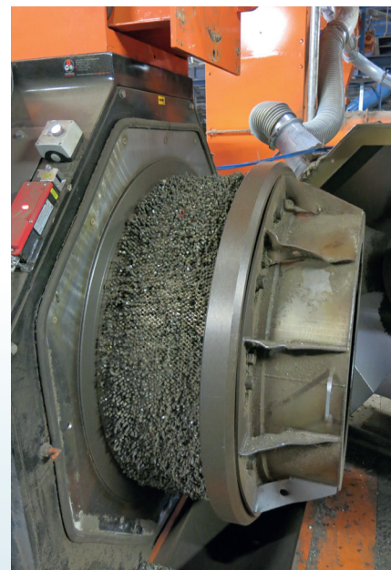
The die of the pellet press
